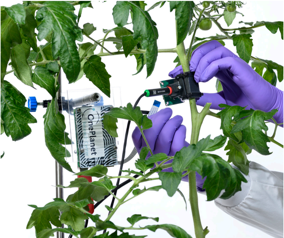
Laser-speckleapparaat, gebaseerd op fotonicatechnologie, bevestigd aan een tomatenplant voor het monitoren van de gezondheid in de plant - OnePlanet Research Center
